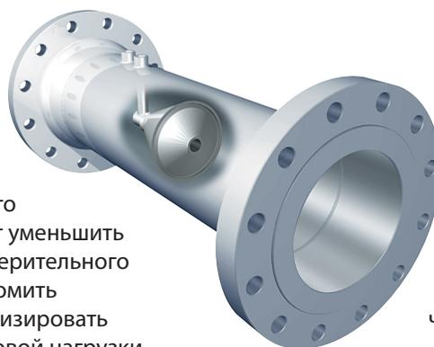
того, встроенный конус V-Cone сконструирован так, что может без значительного износа выдерживать воздействие загрязненных потоков с абразивными и твердыми частицами.
